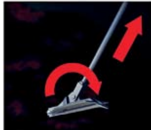
Povlačenjem šipke prema natrag ploča se okreće i stvara snažan otpor
